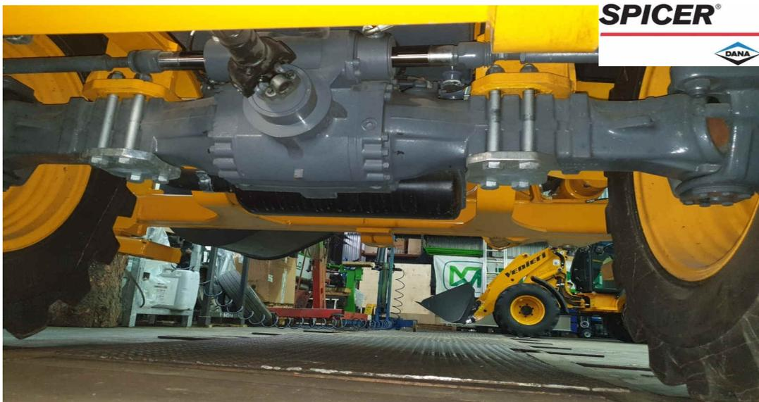
Коробка передач 2-х скоростная с электронно-гидравлическим управлением
