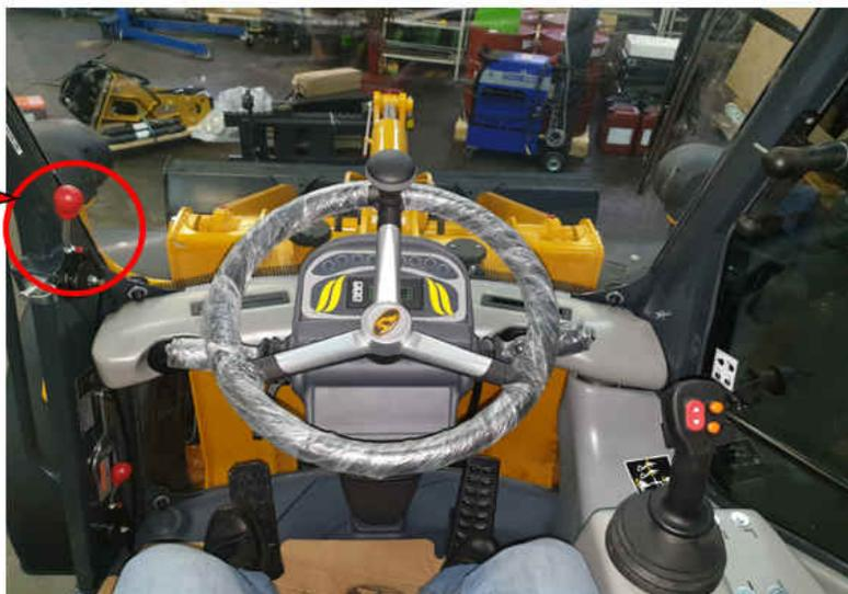
В базовую комплектацию VF10.33B для России включён замедлитель хода, который позволяет эффективно работать машине с щётками для уборки территории.
