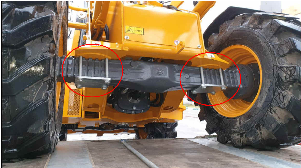
Модель VF10.23C - вид снизу: передний мост жёстко закреплён на шпильках к раме, задний к осциллирующему подрамнику
