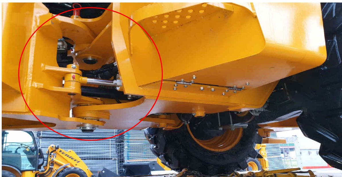
Центральный поворотный шарнир рамы VF10.23C
